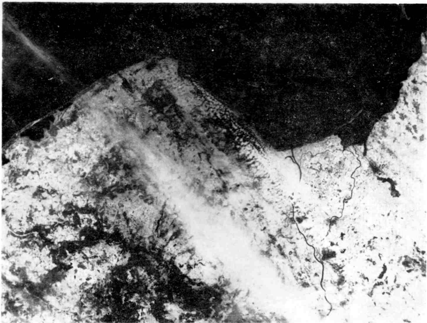
Fot. 3. Zobrazowanie Pomorza Wschodniego wykonane z pokładu satelity ERST-1 20 maja 1974 roku o godzinie 11 w kanale bliskiej podczerwieni (0,8—1,1 \mu\text{m} ) — MSS 7
