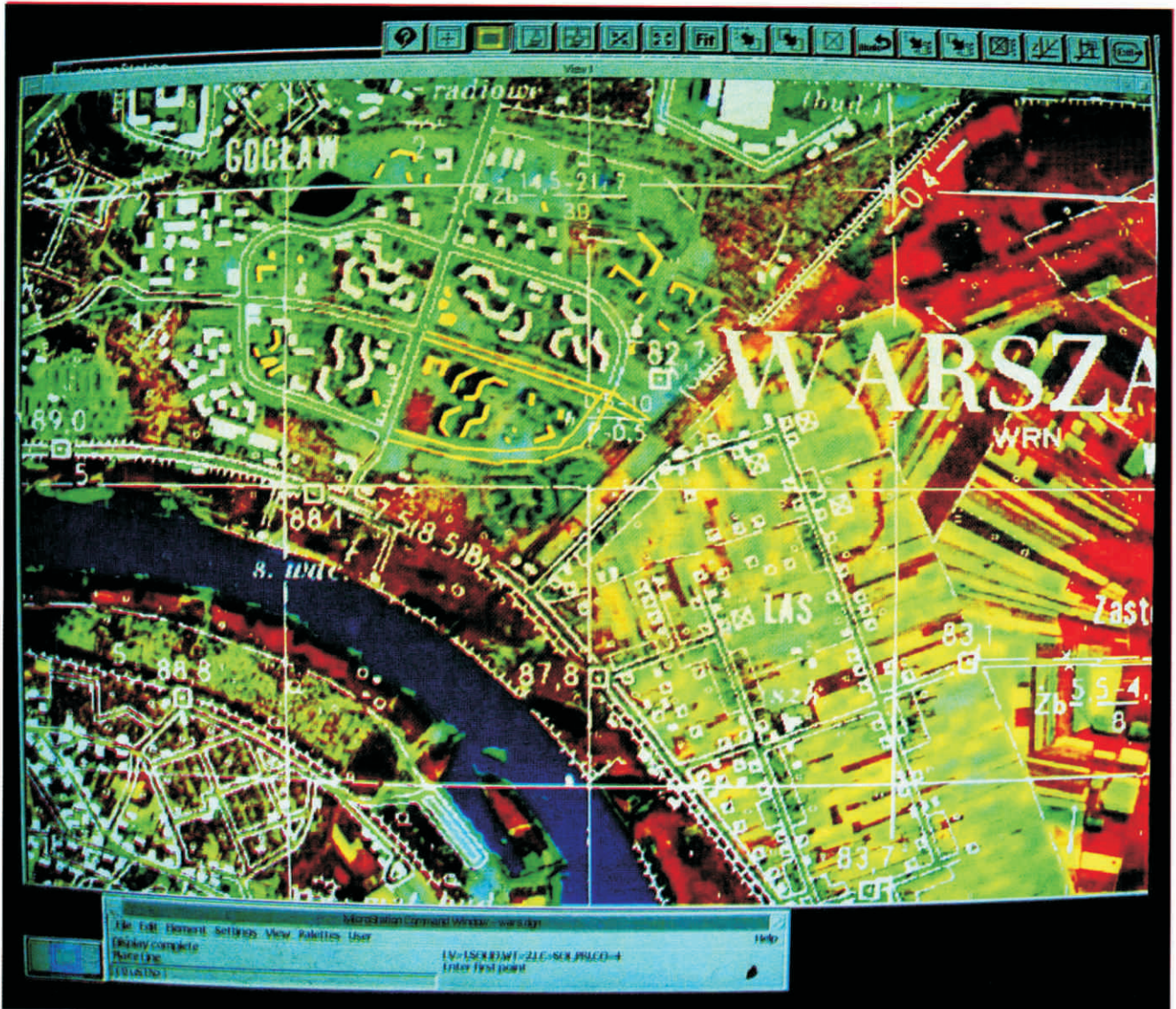
Ryc. 5. Przykład cyfrowej aktualizacji mapy topograficznej w skali 1:50 000 na bazie mapy obrazowej. Kolorem białym pokazano sytuację z mapy topograficznej z roku 1983. Kolor żółty pokazuje ulice i budynki powstałe po roku 1983. Osiedle Goćław. Zdjęcie z monitora
