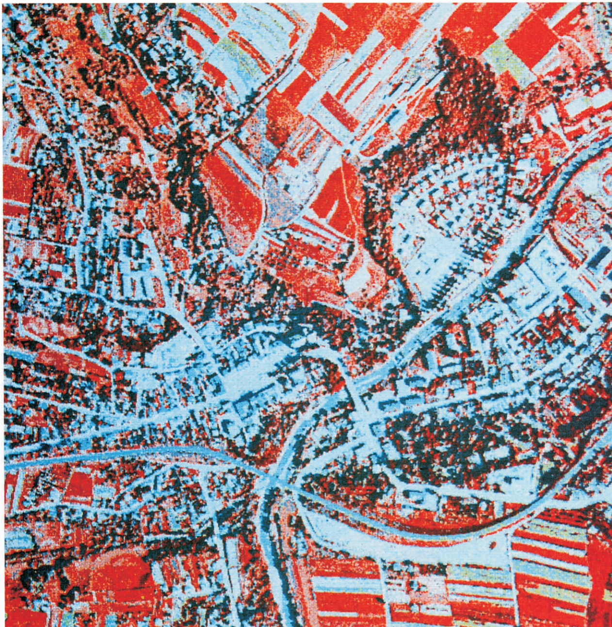
Ryc. 7. Cyfrowa kompozycja barwna nr III, z własną paletą barw, utworzona z wyciągów spektralnych: 3, 4, 6 rzutowanych przez filtry R, G, BA
