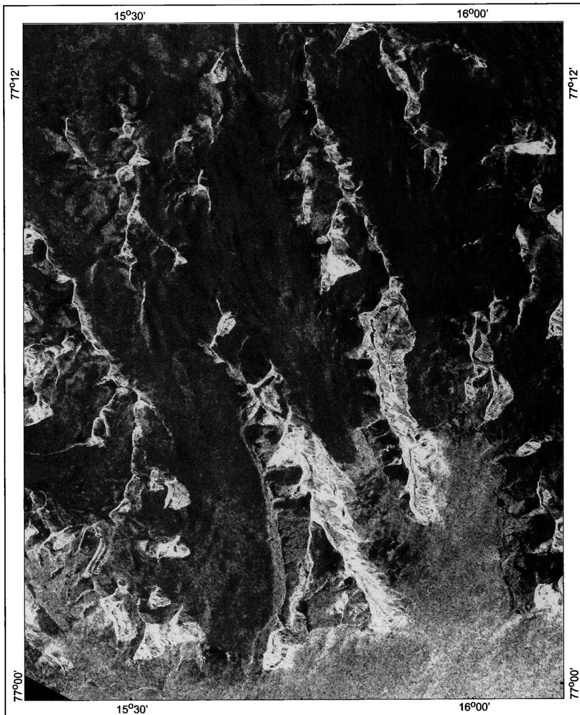
Ryc. 22. Obraz radarowy po korekcji geometrycznej, radiometrycznej i redukcji plamkowania, 1:135 000
