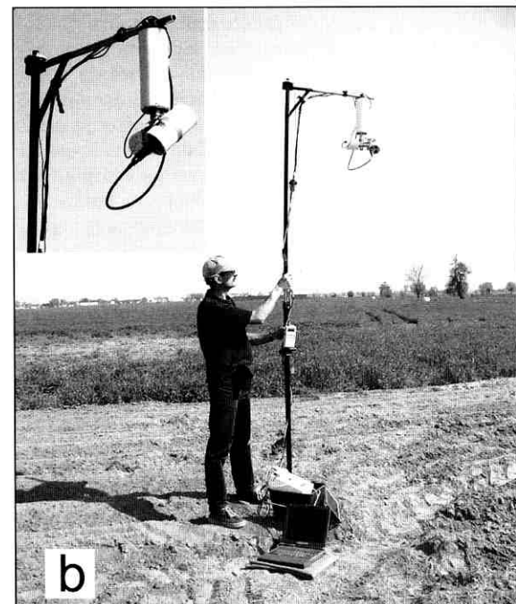
Ryc. 3. Statywy umożliwiające ręczną (a) i automatyczną (b) zmianę pozycji głowicy luminancjometru CIMEL (wg Cierniewski, 2001).
