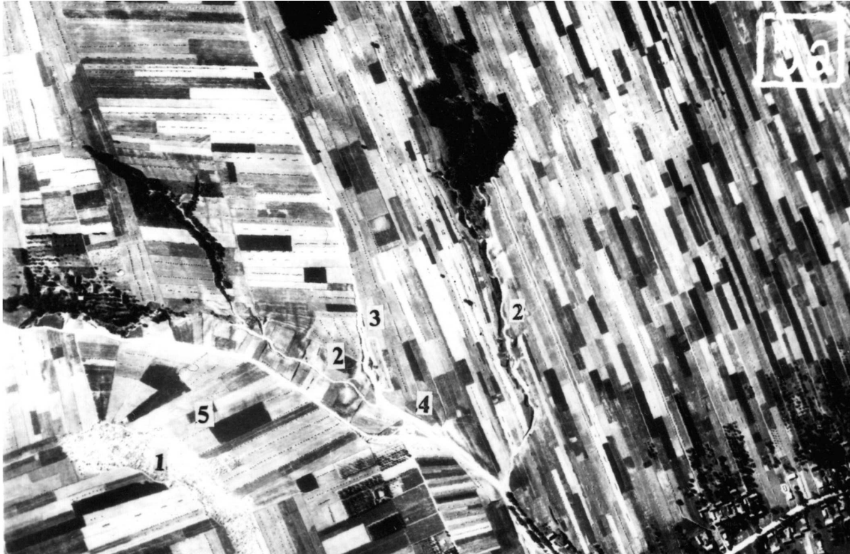
Fot. 5a. Przejawy erozji powierzchniowej na stokach i erozji liniowej na drogach. 1 - Kredowe podłoże wyłaniające się spod zmytej gleby; 2 - częściowo zadrzewione wąwozy skłonowe z wąwozami bocznymi; 3 - powiększające się wąwozy drogowe; 4 - wyerodowane nieużytki drogowe; 5 - stony z silniejszą erozją powierzchniową. Fotomapa w skali 1:5000.
